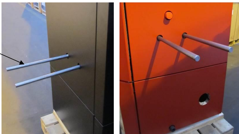
Figura1 Manipularea cazanului cu ajutorul suportului
